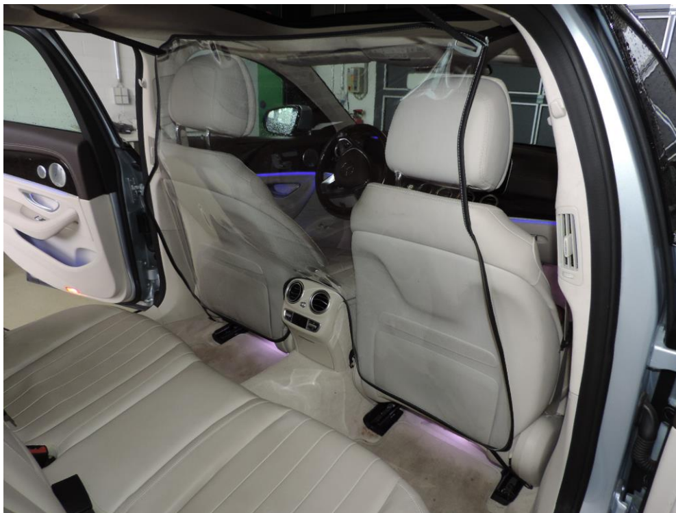
Abbildung 3: Einbauposition Trennwand - Diagonale hinten rechts (Fahrzeug: Mercedes-Benz E - Klasse BR213, Typ: R1ES)
