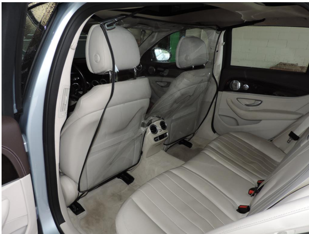
Abbildung 4: Einbauposition Trennwand - Diagonale hinten links (Fahrzeug: Mercedes-Benz E - Klasse BR213, Typ: R1ES)
