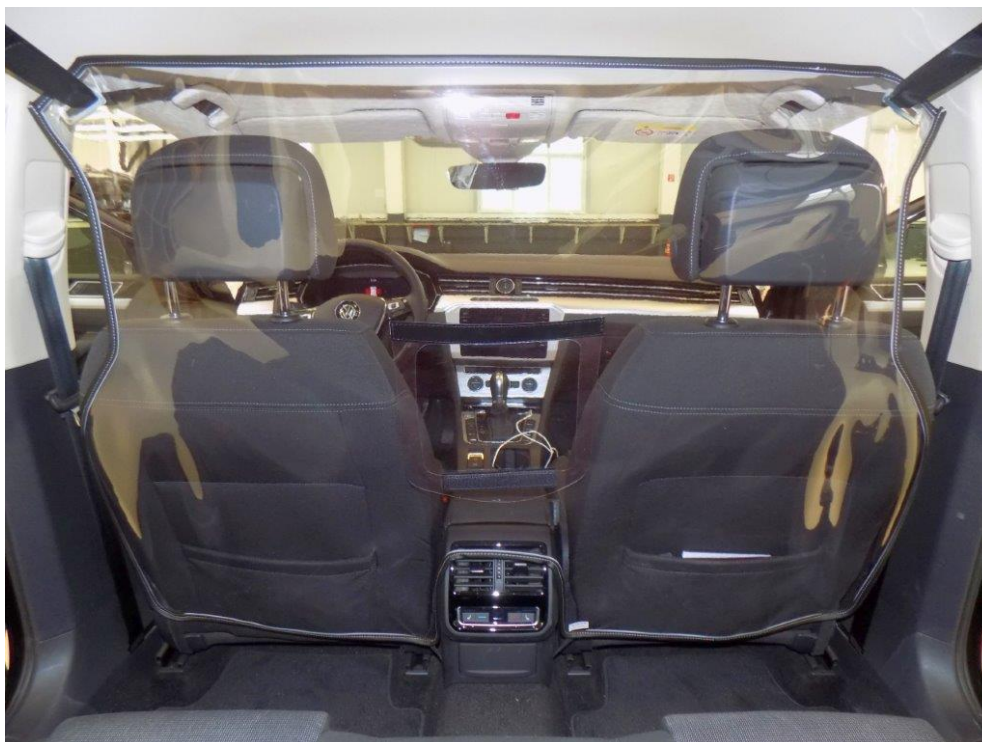
Abbildung 5: Einbauposition Trennwand mit Durchreiche - Frontalansicht (Fahrzeug: Passat B8, Typ: 3C)
